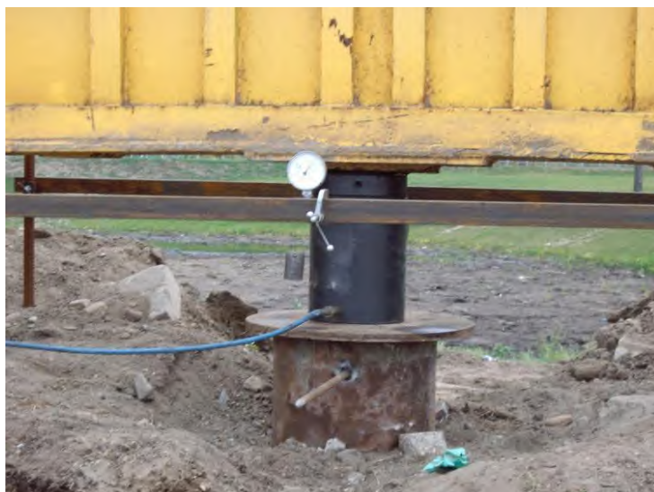
1.4 pav. Nuosėdžių matavimo indikatorius sumontuotas ant nepriklausomo sijyno
