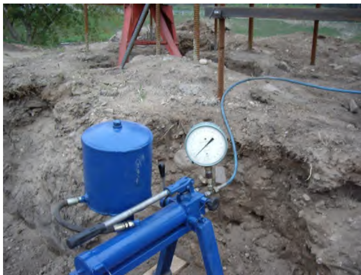
1.3 pav. Rankinė hidraulinė siurblinė
